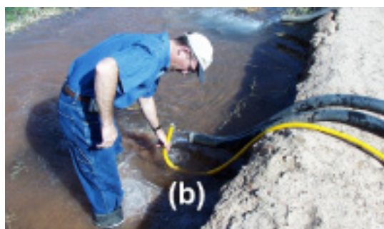
Figura 6. Tres fotos en donde se muestra cómo medir "la caída" en un sistema abierto. La caída es la distancia desde el nivel del agua en el canal hasta el nivel del agua en el campo. (a) Use la manguera para sifonear agua desde el canal; (b) Levante la manguera hasta que el agua deje de fluir y salir por la boca de la manguera; (c) Mida la distancia entre el extremo de la manguera y el nivel del agua en el campo.
